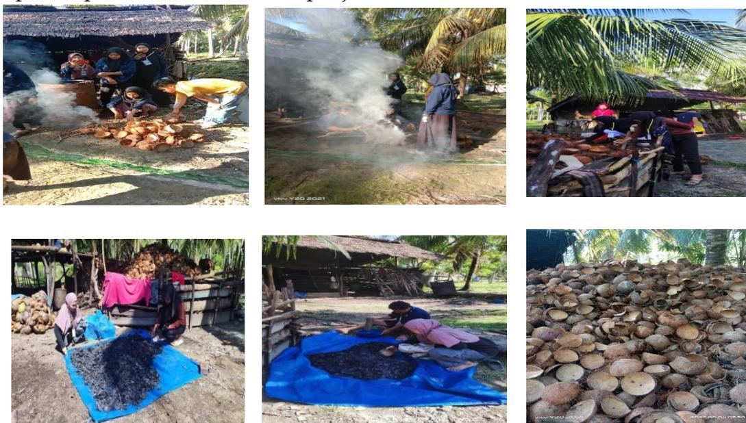
Gambar 2: Proses pemilahan tempurung kelapa, pembakaran, penjemuran arang, dan penghalusan arang tempurung kelapa.
